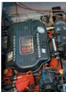
Pode usar um ou dois de centro-rabeta, a diesel ou a gasolina. A diesel, a potência varia de 300 hp (um só motor) a 400 hp (dois motores de quatro ou cinco cilindros). Já na versão a gasolina, varia de 375 hp (um só motor) a 540 hp (dois motores, como no barco testado).
