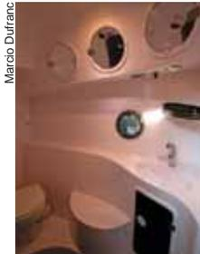
Não tem boxe fechado, mas é grande para uma lancha de 30 pés, com 1,83 m de altura, 1,50 m de comprimento e quase um metro de largura. É bem ventilado e tem três porta-trecos para guardar material de higiene. Para melhorar a iluminação natural, há uma clarabóia no teto, sob o pára-brisa.
