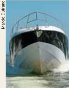
Muito bem-feita, com ferragens de aço inox 316L. É laminada com tecidos de fibra de vidro biaxiais, mais leves e resistente que os tradicionais, e estrutura com núcleo de espuma de PVC acima da linha d'água. Tem certificação para o mercado europeu.
