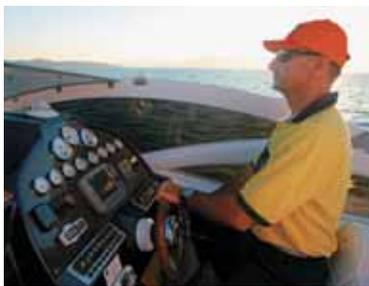
Os bancos do piloto e do acompanhante são individuais e a visibilidade boa, mesmo através do pára-brisa, que tem laterais em forma de arco duplo. Para melhorar a visibilidade, os assentos podem ser rebatidos. O painel saliente, com bom espaço para os instrumentos do motor e os eletrônicos, torna o pilotar ainda mais confortável.
