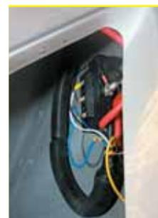
A instalação, com fios estanhados, atende as normas da americana ABYC, o que torna esta lancha bem segura. Os fios no paiol da âncora, porém, são soltos, e podem enroscar na corrente. Por sua vez, a instalação hidráulica inclui tanque de esgoto de 60 litros, para evitar poluição nas águas.
