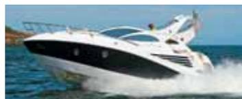
**Onde e como testamos** A 300M Cabrio principal foi testada na parte norte da ilha de Florianópolis, em dia com ventos de 14 nós e ondas de 70 centímetros. A bordo, havia três pessoas, 240 litros de gasolina e 130 litros de água. Estava equipada com dois motores de centro-rabeta a gasolina, da Volvo, modelo 5.0 GXi, V8, 5 litros, 270 hp cada, com rabetas DPS-A (hélices contra-rotantes), relação de transmissão de 1,95:1 e hélices de aço inox F4.
