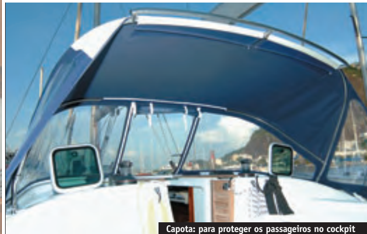
Capota: para proteger os passageiros no cockpit
