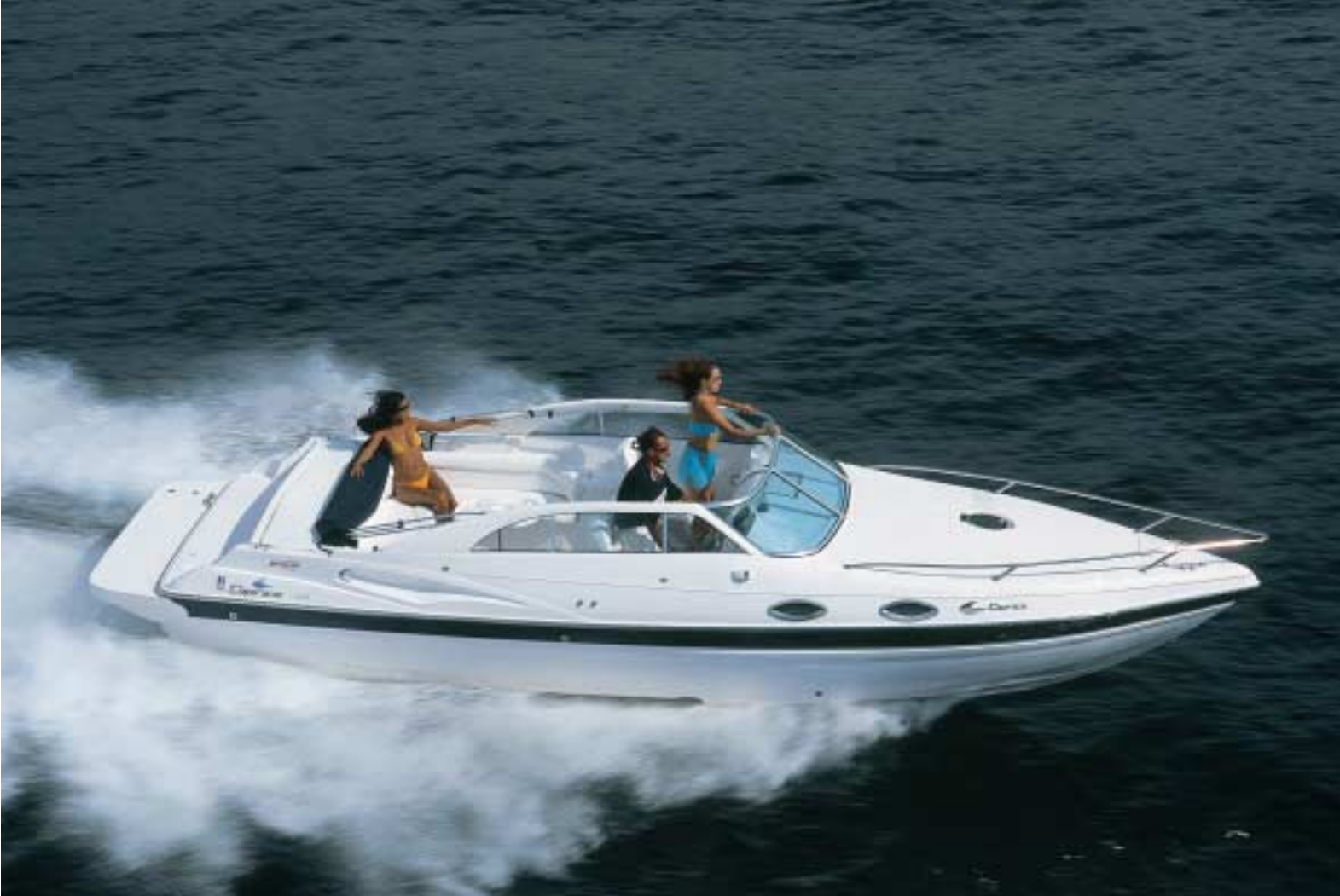
O casco com degrau da Caprice 270 corta bem as marolas baixas e tem bom desempenho com motor de média potência
