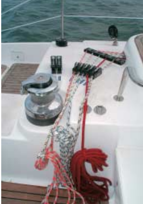
Catracas têm acionamento elétrico
