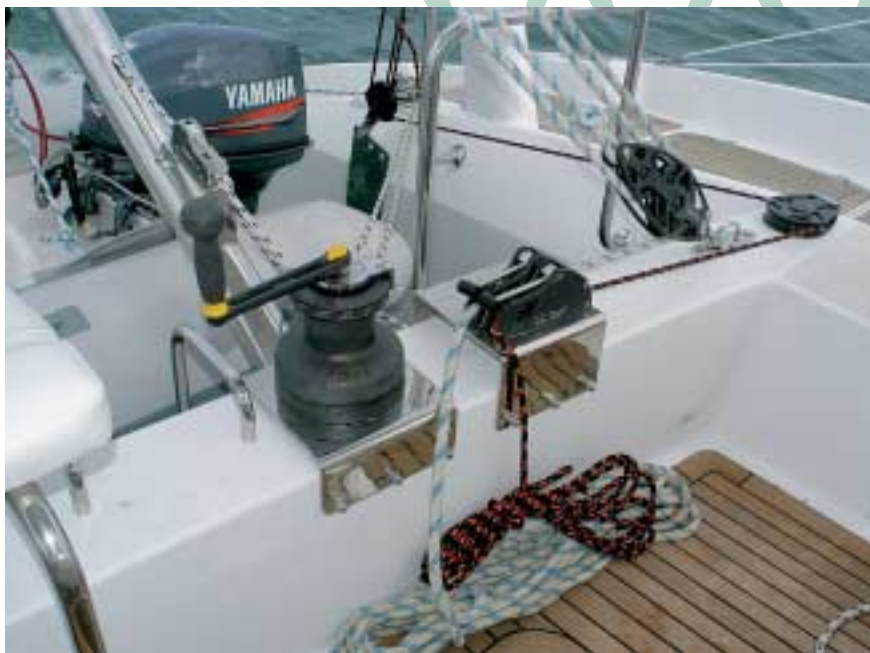
Operados simultaneamente, os conjuntos de redução da mestra atuam como burro
