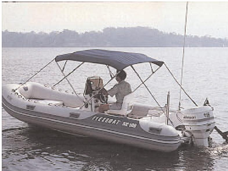
A qualidade da construção também é indiscutível, a começar pela resistência do casco, laminado com várias mantas — oito na quilha. E como em todo Flexboat, a parte inflável é fabricada inteiramente com tecido francês à base de hypalon, poliéster e neoprene — componentes que garantem resistência e vida longa.
