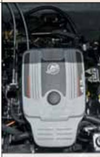
Usa um centro-rabeta de 120 a 225 hp, a diesel ou a gasolina. O compartimento do motor tem bom espaço para manutenção. A entrada e a saída de ar são um pouco pequenas, o que pode comprometer o funcionamento do motor.
