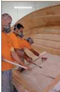
É bem forte. O casco foi laminado da forma tradicional, com camadas de manta, tecido biaxial e triaxial e gelcoat isoftático, que é bem resistente à osmose. A laminação tem bom padrão de acabamento.
