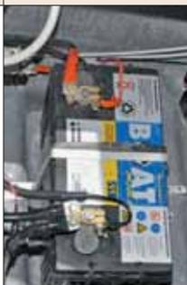
Não usa fiação elétrica estanhada, que resiste melhor à maresia, nem codificada, como seria o ideal, mas a instalação foi benfeita. A chave-geral fica bem protegida da água e em local de fácil acesso.
