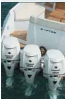
Podem ser de popa ou centro-rabeta. São indicados, no mínimo, dois de 300 hp cada e no máximo três, de 350 hp. No barco testado, a montagem do trio de popa de 300 hp foi bem-feita, faltando só ajustes. Os comandos eletrônicos ajudaram muito na navegação.
