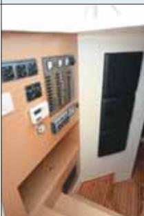
A fiação não é codificada, mas é estanhada. O painel elétrico fica bem visível, ao lado da escada da cabine, junto com o controle do gerador e do ar refrigerado, que são itens opcionais.
