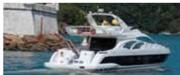
**Onde e como testamos** A Intermarine 680 Full IPS foi testada com ondas de 1,0 metro e vento de 12 nós. A bordo, cinco adultos, 3 700 litros de combustível e 800 litros de água. A lancha estava equipada com quatro motores diesel Volvo IPS 600, com 435 hp no virabrequim cada, acoplados a rabetas IPS, com relação de transmissão de 1,82 e hélices contra-rotantes de níbral, especificação T3.
