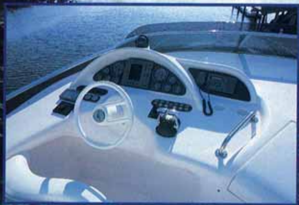
Comando superior Painel na medida para os principais relógios da motorização, eletrônicos e bússola
