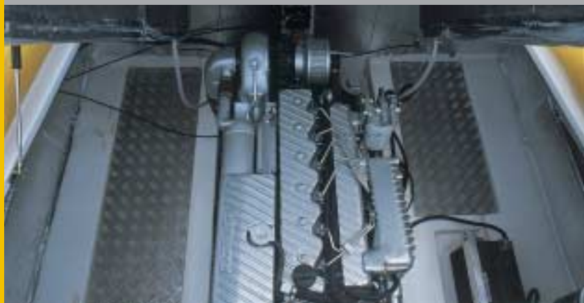
É bom o desempenho com motorização Megatech a diesel de 285 cv
