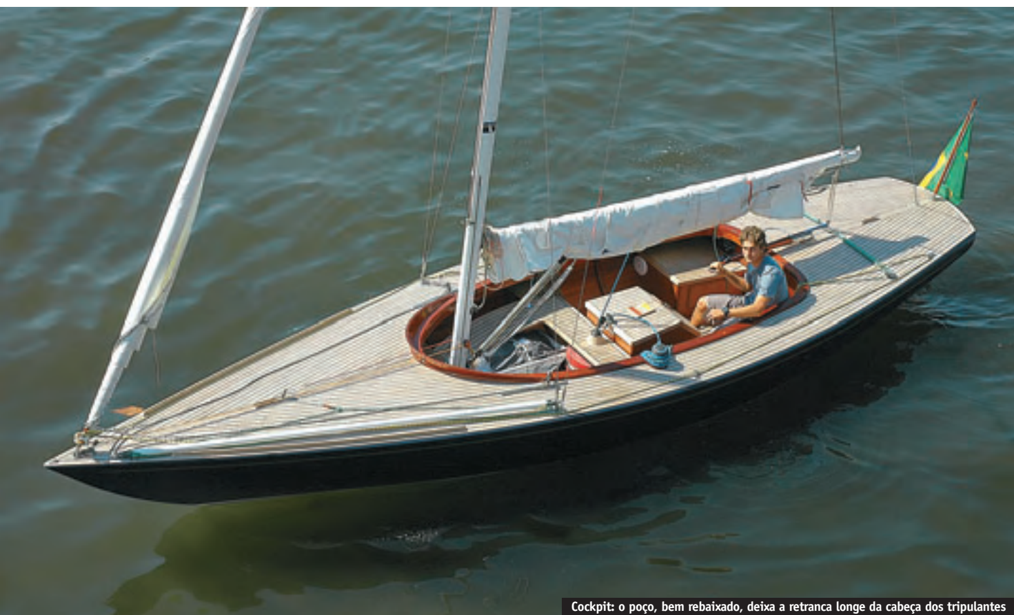
Cockpit: o poço, bem rebaixado, deixa a retranca longe da cabeça dos tripulantes
