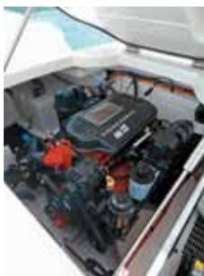
Apenas um, de centro-rabeta, seja ele a diesel (de 165 hp a 190 hp) ou a gasolina (de 220 até 320 hp). Neste teste, o motor Volvo de 300 hp, a gasolina, formou um excelente conjunto com o casco, proporcionando potência de sobra para passeios ou para puxar esquiadores menos exigentes.
