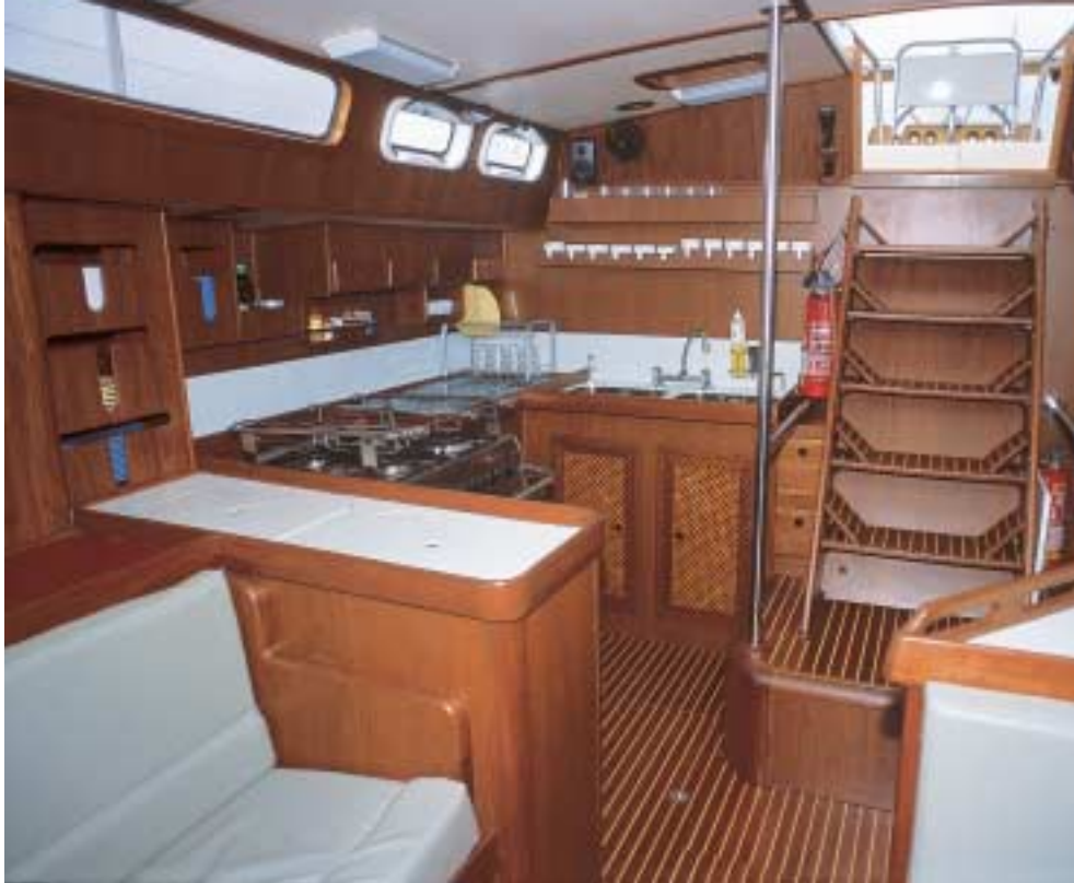
A cozinha, em "U", dispõe de fogão de quatro bocas montado sobre eixo cardã e duas pias com água doce quente e fria e água salgada para lavagens triviais
