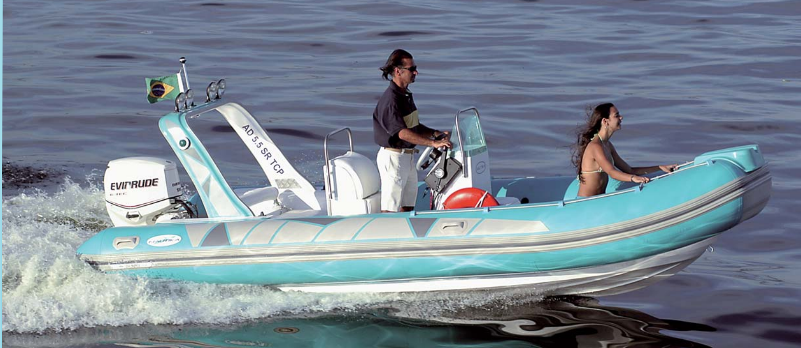
O barco tem bom desempenho com motor de 90 hp. A parte inflável tem quatro compartimentos independentes
