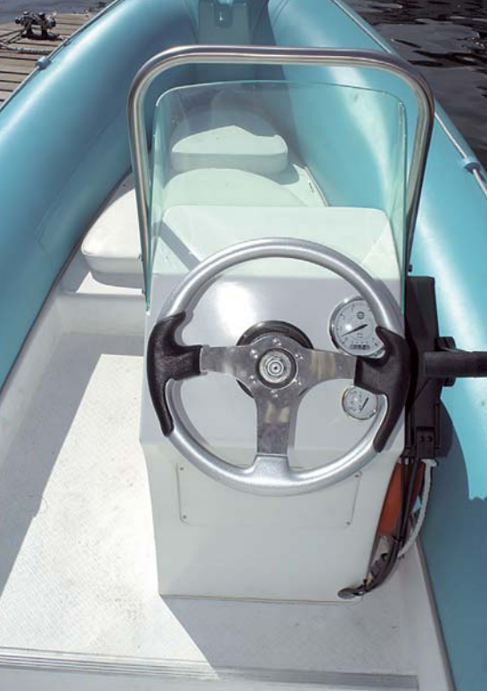
O painel no console tem espaço para instrumentação básica, bússola e eletrônicos compactos. O assento do piloto é rebatível
