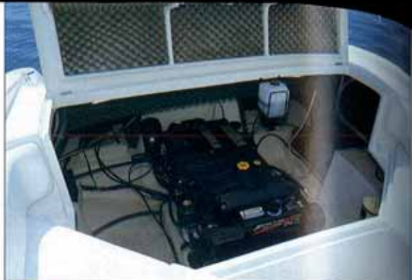
Motor Bom espaço para manutenção ao redor do Mercruiser diesel de seis cilindros e 225 hp no hélice
