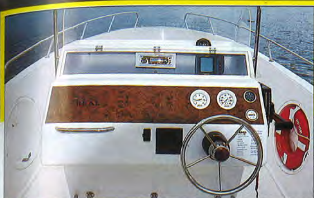
Painel Proteção de acrílico protege os instrumentos
