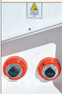
Localizado ao lado do painel, o quadro elétrico tem fácil acesso e visualização. Mas a fiação não é estanhada nem codificada. Há duas chaves de bateria, uma para motor e outra para serviço, ambas no cockpit, protegidas sob tampas de acrílico no costado.
