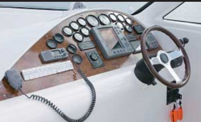
O painel é grande o suficiente para acomodar eletrônicos e os relógios. Na garagem de 3 m por 0,97 m, há espaço para o bote
