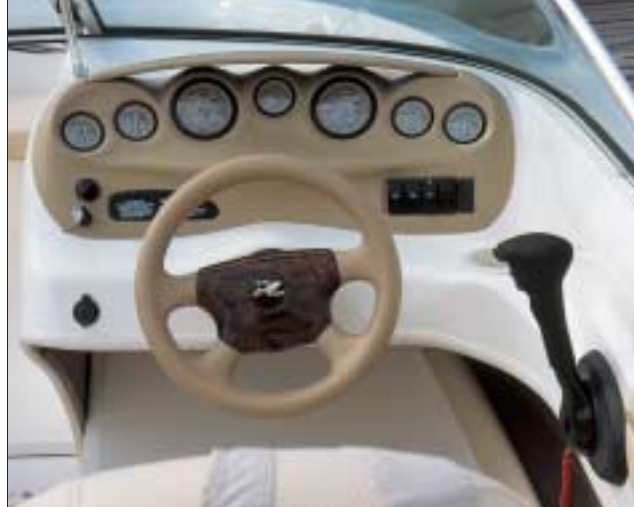
Painel Com desenho elegante, ele tem espaço para dois relógios grandes, cinco pequenos e quadro de disjuntores
