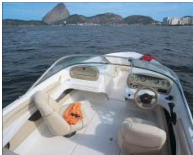
Cockpit As cadeiras do piloto e do carona, além de giratórias, têm regulagem para aproximação do painel
