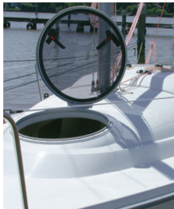
Proa A gaiúta circular, de 51 cm de diâmetro, soma pontos ao design do barco e ventila naturalmente a cabine
