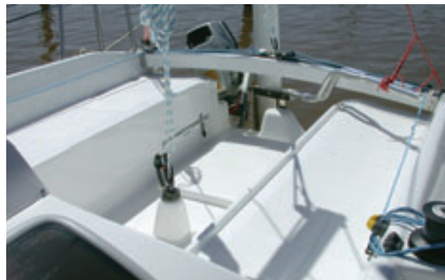
Cockpit O trilho do traveller — acessório opcional — é fixado na aresta superior do espelho da popa
