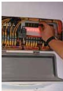
As fiações não são codificadas, mas o estaleiro promete mudar isso nas próximas lanchas. A instalação elétrica foi dimensionada para alimentar vários equipamentos elétricos, como TV, microondas e ar-condicionado. O quadro de fusíveis fica na cabine e é bem acessível para manutenção.
