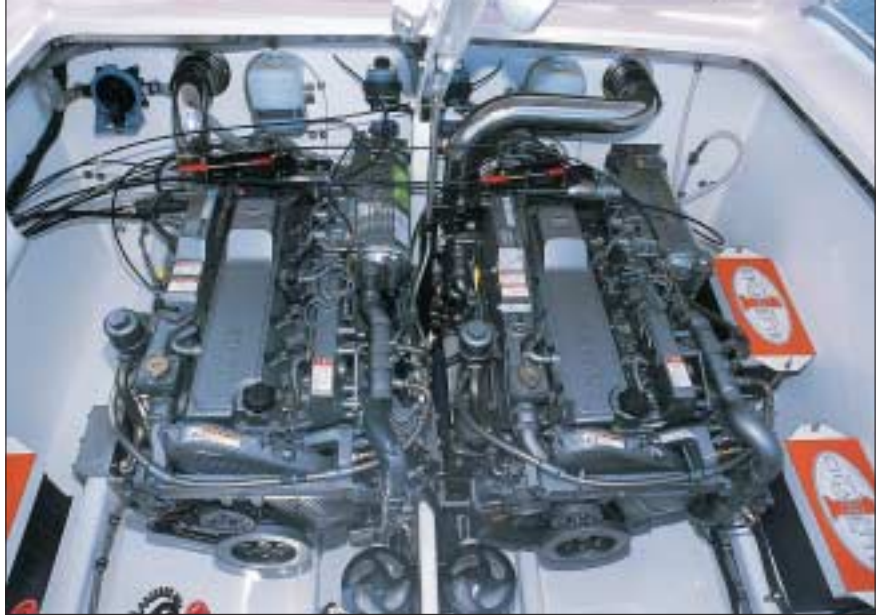
Motorização Os dois motores Yanmar de 6 cilindros são montados com capricho. Há um bom espaço ao redor dos propulsores para a manutenção de rotina
