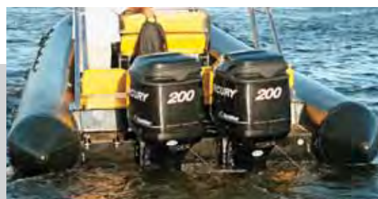
BEM VELOZ Com um par de motores de popa de 200 hp cada, este Tecnoflex chegou a 49,5 nós
