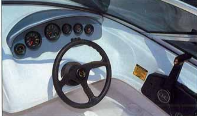
Painel Tem espaço para seis relógios do motor e para bússola pequena e quadro elétrico com três interruptores
