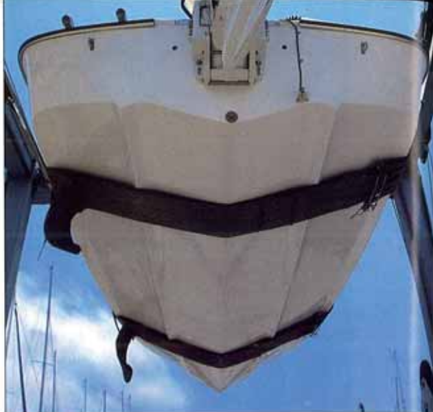
Casco Com um bom projeto, corta suavemente marolas pequenas sem transmitir o choque para os passageiros
