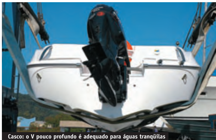
Casco: o V pouco profundo é adequado para águas tranquilas
