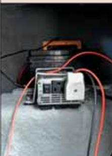
A fiação é estanhada e codificada, o que é o ideal, e há um bom painel elétrico sob o console. A bateria é bem protegida dos respingos. Já o inversor fica no porão, o que é ruim, por se tratar de um ambiente úmido, com risco de curto-circuito.
