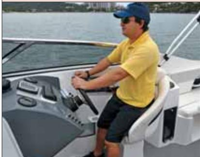
A visibilidade é boa para todos os bordos, mas o banco do piloto fica próximo demais do volante quando se pilota sentado e não tem regulagem para frente ou para trás. Fica mais confortável quando rebatido. A leitura dos instrumentos e do gps é prejudicada pelos reflexos do sol.
