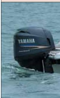
O estaleiro recomenda um motor de popa entre 115 hp e 150 hp. No teste, a lancha estava equipada com um de 115 hp, potência que se mostrou suficiente para os passeios e até para puxar esqui. Isso é sinal de que ela talvez seja capaz de usar até um motor de apenas 90 hp.
