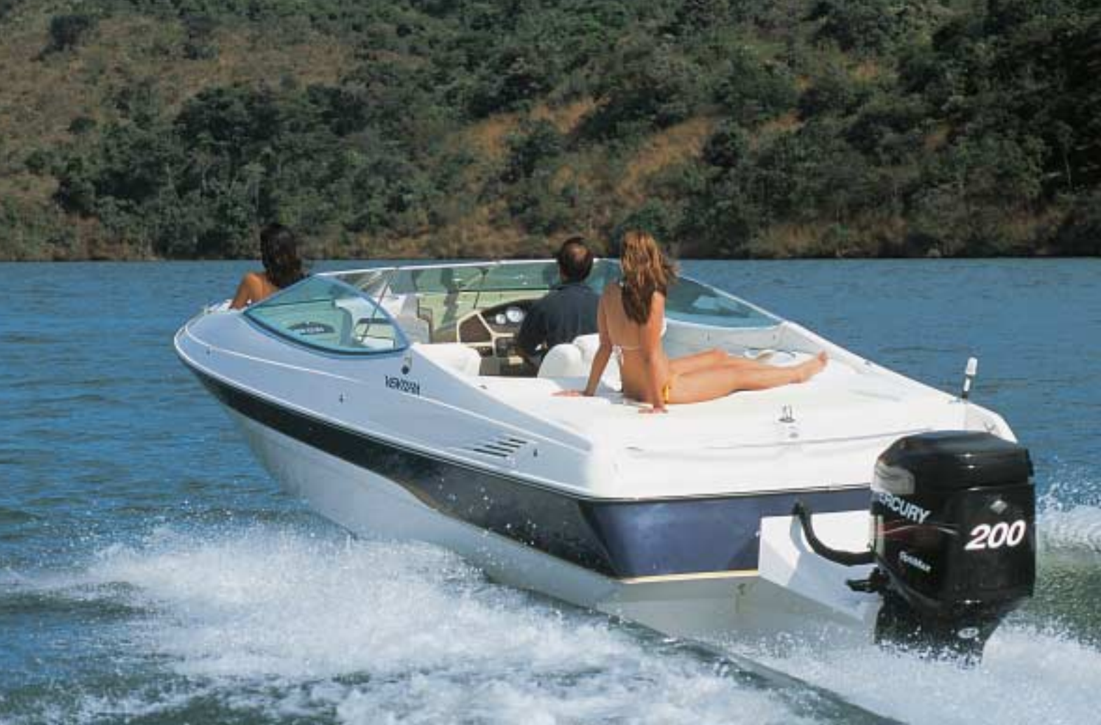
A montagem sobre cavalete deixa o motor mais exposto, porém melhora o desempenho e a manobrabilidade da lancha
