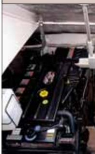
Pode usar dois motores de centro-rabeta a diesel, com potência total de 400 a 700 hp. Mas a motorização mínima já é suficiente para levar esta lancha a uma boa velocidade final de 39 nós. O acesso aos motores é bom e o piso é antiderrapante.
