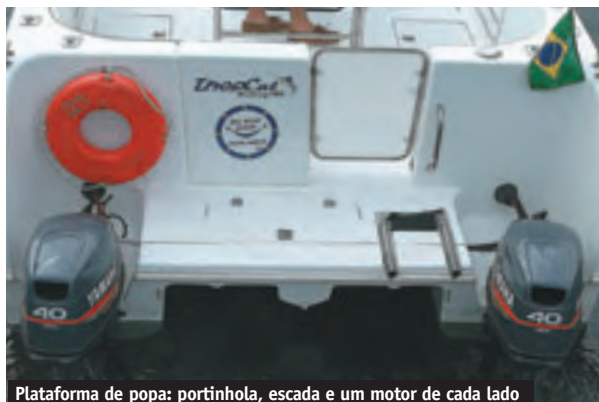
Plataforma de popa: portinhola, escada e um motor de cada lado
