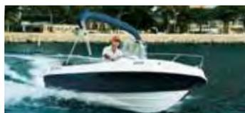
**Onde e como testamos** A Top Fish 16 foi testada na Baía de Guanabara, com ventos de 6 nós e marolas de meio metro. A bordo, havia duas pessoas e 25 litros de combustível. A lancha estava equipada com um motor Mercury dois tempos de 50 hp, três cilindros, 966 cm<sup>3</sup>, equipado com hélice de alumínio, com três pás de passo 13". A relação de transmissão da rabeta era de 1,83:1.
