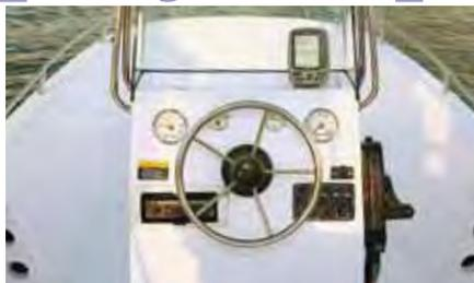
O console está bem posicionado em relação ao piloto, mas o manete é lateral, um pouco mais difícil de manusear que o do tipo tope. No painel, junto ao timão, cabem os instrumentos do motor. Os eletrônicos ficam em cima.
