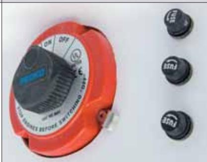
É bem-feita, com fios estanhados, codificados e fusíveis de proteção, como, aliás, deveria ser em todos os barcos. A chave geral, com fácil acesso, fica na parte de cima de um dos porta-varas, bem protegida dos respingos d'água.
