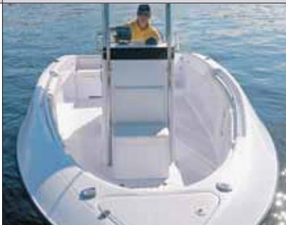
O casco é bem estruturado por cinco cavernas e duas longarinas, o que o torna bem forte. O piso é reforçado com espuma de PVC rígida, que confere leveza ao casco. O gel e a resina usados são do tipo chamado isoftálico, que é mais resistente aos riscos e à osmose.
