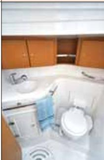
É alto e, além de uma janela de bom tamanho, tem uma boa gaiota, que embora deixe o interior um pouco devassado, dá ventilação e iluminação excelentes. Possui bons armários, bomba elétrica para drenar a água do banho e tanque de contenção de dejetos, de 30 litros, com sistema para descartar nas marinas.
