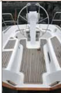
Com 2,70 m de comprimento por 1,85 m de largura, acomoda muito bem quatro pessoas sentadas à frente da roda de leme, que, porém, atrapalha um pouco a circulação. Mas, o estaleiro oferece a opção de cana de leme em vez do timão. Os cabos são fáceis de alcançar.
