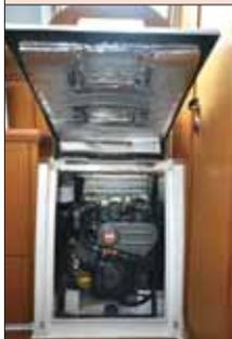
Com um motor Yanmar 3YM30 de 29 hp e rabetá saildrive SD20, chegou a 6 nós de velocidade, a 2 800 rpm, marca dentro da média para um veleiro. O motor fica em um compartimento atrás da escada da cabine, que tem iluminação e isolamento acústico correto.
