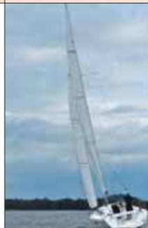
O mastro é de alumínio, fracionado em 9/10, com duas cruzetas anguladas. Na versão de cruzeiro, é apoiado sobre o convés e na de regata, desce até a quilha. O pau de spinnaker fica preso ao mastro, sem atrapalhar o cockpit. A retranca tem boa altura para não bater na cabeça dos tripulantes. E, na versão regata, é mais longa.
